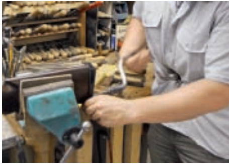
Die Schaftkappe wird provisorisch angeschraubt.
