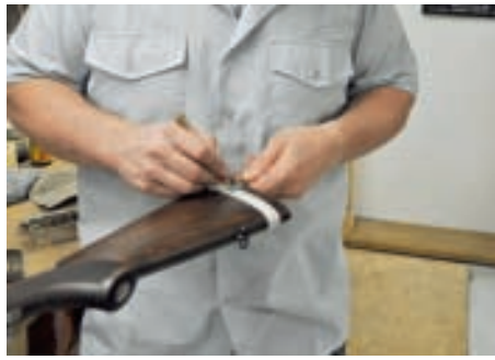
Hier wird angezeichnet, wo der Schaft abge-sägt werden soll.
