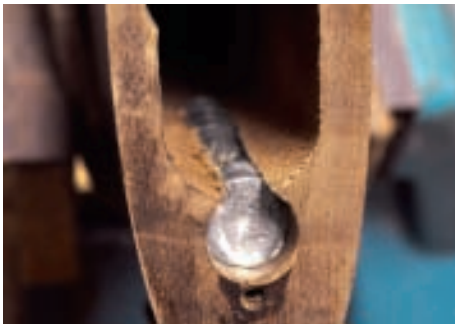
Mit einer Bohrung im Schaft wird Platz für das Gegengewicht aus Blei geschaffen.
