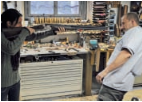
Diese Flinte ist zu lang. Der Schaft muss gekürzt werden.
