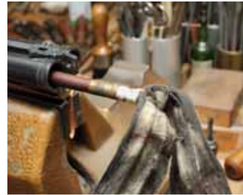
Der Putzstock kann auch dazu verwendet werden, um Putzlappenstreifen durchzuziehen.
