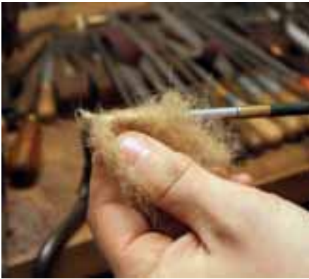
Das Auswischen erfolgt mittels Putzlappen oder Filzpfropfen, aber auch Hanfwerk ist dafür geeignet.
