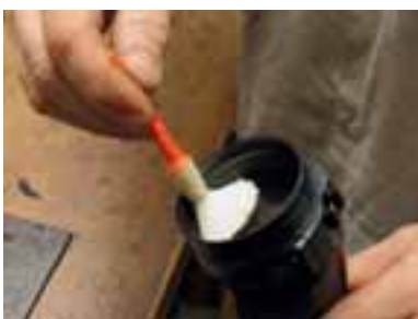
Mit einem Pinsel werden feine Schmutzpartikel von den Optiklinsen entfernt.
