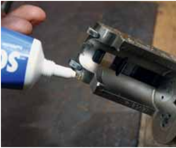
Laufhaken und Verriegelungsflächen benötigen etwas Fett.
