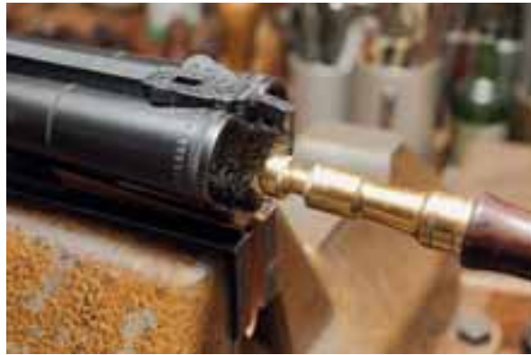
Der Flintenlauf wird mit ölgetränkter, feiner Stahlwolle oder einem Broncewischer gereinigt. Auch hier gibt es für das Patronenlager spezielle, dem jeweiligen Kaliber entsprechende Bürsten.
