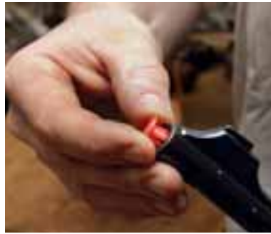
Um auf der Jagd das Eindringen von Fremdkörpern in den Lauf zu verhindern, können spezielle Mündungsschoner benutzt werden, die im Fachhandel erhältlich sind.
